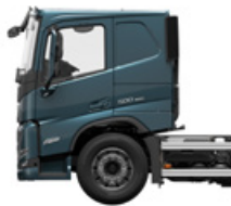
Cabina dormitorio con techo bajo
