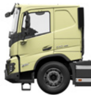
Cabina dormitorio con techo bajo
