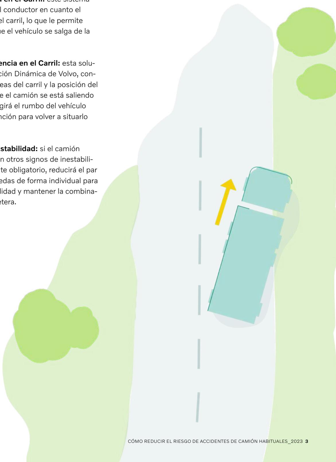
■ **Asistencia para la Estabilidad:** este sistema, habilitado por la Dirección Dinámica de Volvo, puede ayudar a evitar cualquier derrape o inestabilidad que pueda provocar que el camión se salga de la carretera.
